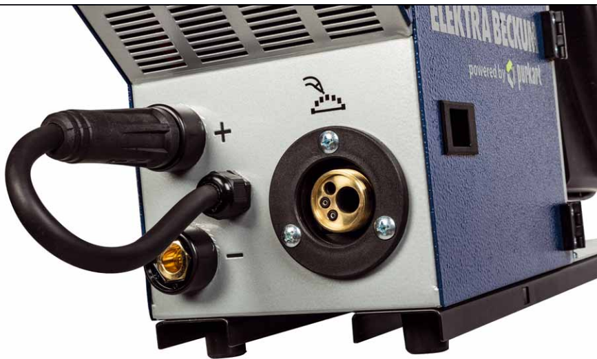
An dem großen Stecker wird das Schlauchpaket des MIG/MAG-Schweißgerätes angeschlossen, WIG- und Elektrodenschweißen wird über die Plus- und Minus-Anschlüsse erledigt
